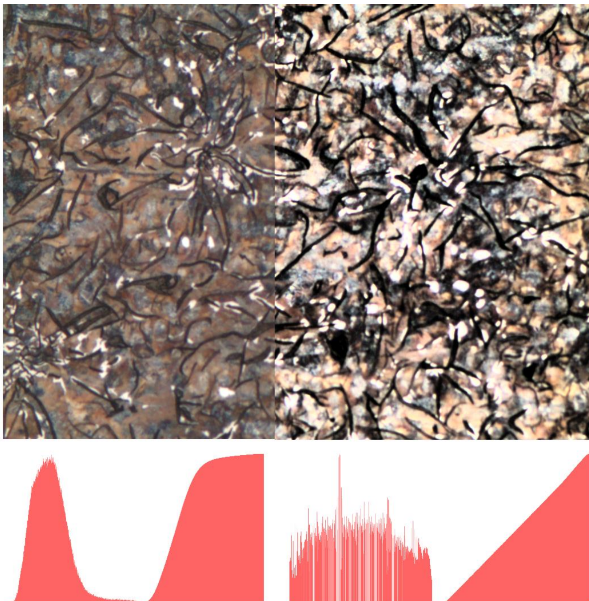
Obr. 2.5.1: Mikrosnímek feritu upravovaný ekvalizací histogramu. Vlevo původní snímek s původním histogramem a kumulovaným histogramem, vpravo ekvalizovaný snímek s ekvalizovanými histogramy.
