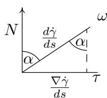
V neinflexním bodě vektor  $\frac{d\dot{\gamma}}{ds}$  leží v oskulační rovině. Z obrázku, na němž je nakreslen řez rovinou kolmou na oskulační rovinu  $\omega$  křivky  $C$ , plyne  $\left\| \frac{\nabla \dot{\gamma}}{ds} \right\| = \left\| \frac{d\dot{\gamma}}{ds} \right\| \sin \alpha$ . V inflexním bodě je  $\frac{d\dot{\gamma}}{ds} = 0$ , takže také  $\frac{\nabla \dot{\gamma}}{ds} = 0$ .  $\square$
