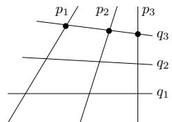
**10.7.** Na přímkové ploše, která není regulární přímkovou kvadrikou ani částí roviny, mohou tedy vedle tvořících přímek ležet nejvýše dve další přímky. S tím souvisí následující obecná konstrukce. Vezmeme dvě mimoběžky  $q_1, q_2$  a křivku  $C$ . Každým bodem křivky  $C$  vedeme příčku obou mimoběžek. Tím dostáváme jednoparametrickou soustavu přímek.
