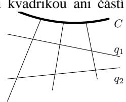
Významný pro technickou praxi je případ, kdy jedna z mimoběžek je nevlastní přímka nějaké roviny  $\varrho$ . Máme tedy dánu rovinu  $\varrho$ , přímku  $q$  a křivku  $C$ . Každým bodem křivky  $C$  pak vedeme přímku, která protíná  $q$  a je rovnoběžná s  $\varrho$ . Takto vzniklá jednoparametrická soustava přímek se nazývá **konoid**. Je-li přímka  $q$  kolmá na rovinu  $\varrho$ , hovoří se o **přímém konoidu**.
